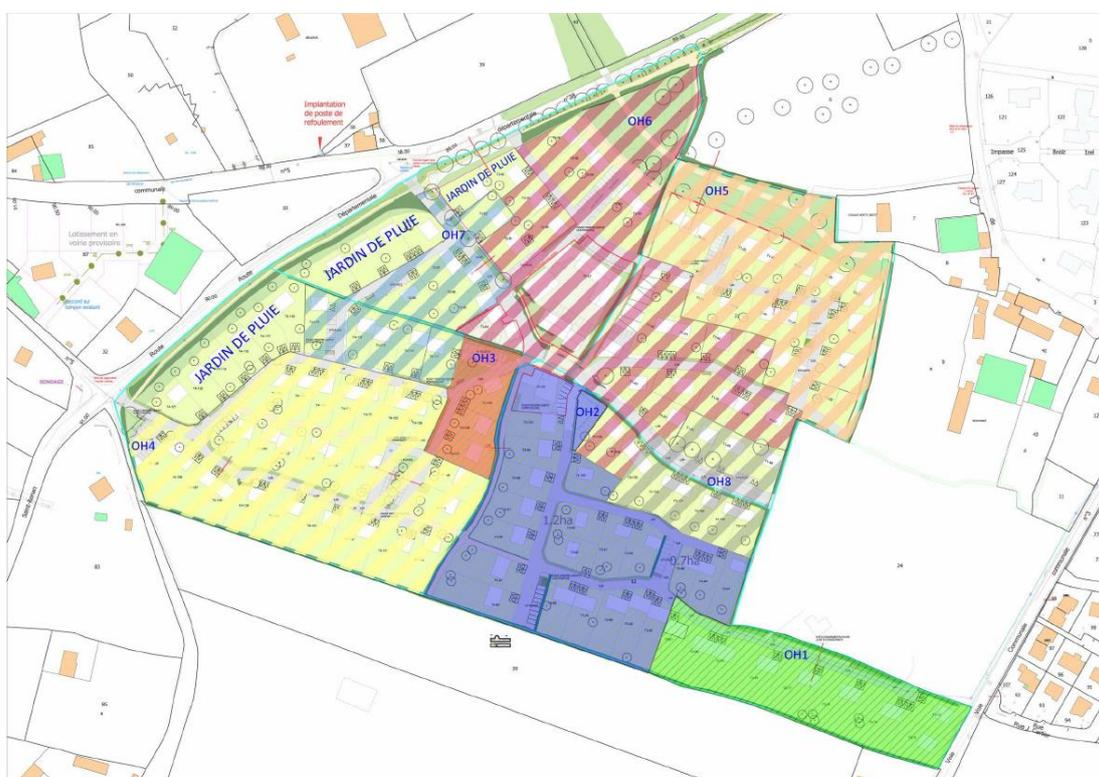
FIGURE 22 : EMPLACEMENT DES OUVRAGES DE GESTION DES EAUX PLUVIALES SUR LE PERIMETRE DU PROJET DE LOTISSEMENT
