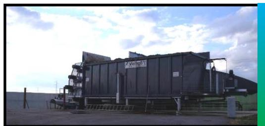
Ce système consomme peu de travail horaire. Une adaptation spécifique aux substrats pailleux sera mise en place, avec des fraises de décompactage pour le fumier.
