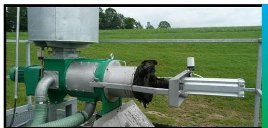
La séparation de phase en amont de la fosse de reprise du digestat liquide permet d'augmenter la capacité de stockage de digestat. En effet, environ 25% du volume sera sous forme solide, et stocké sur une aire de stockage prévue à cet effet : la quantité anticipée de matières solides après séparation de phases est de 2 717 tonnes annuelles, alors que 8 150 tonnes se trouveront sous la forme liquide.
