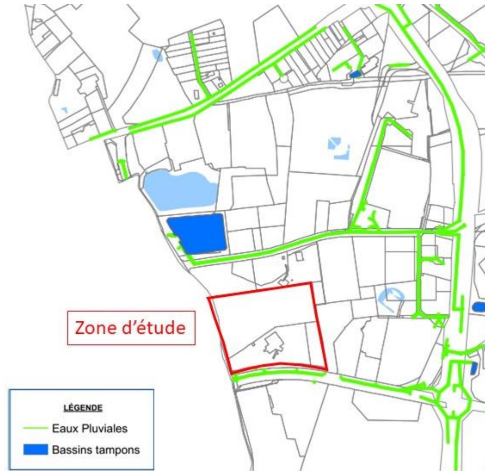
Figure 16 : Réseau d'eaux pluviales au niveau de la zone d'étude
