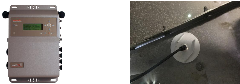
Figure 3 Illustrations d'un SM3BAT et de la protection du microphone
