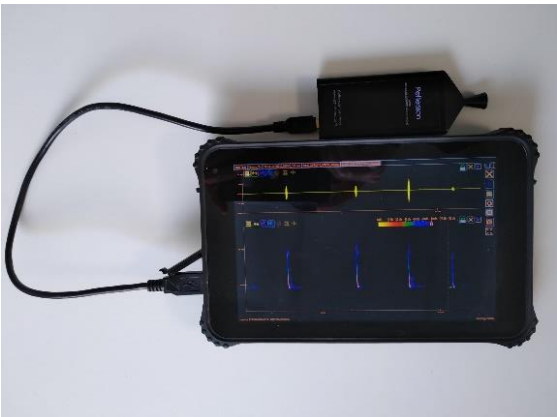
Photo 1 - Détecteur ultrasons Pettersson M500 et logiciel « Batsound Touch » sur tablette
