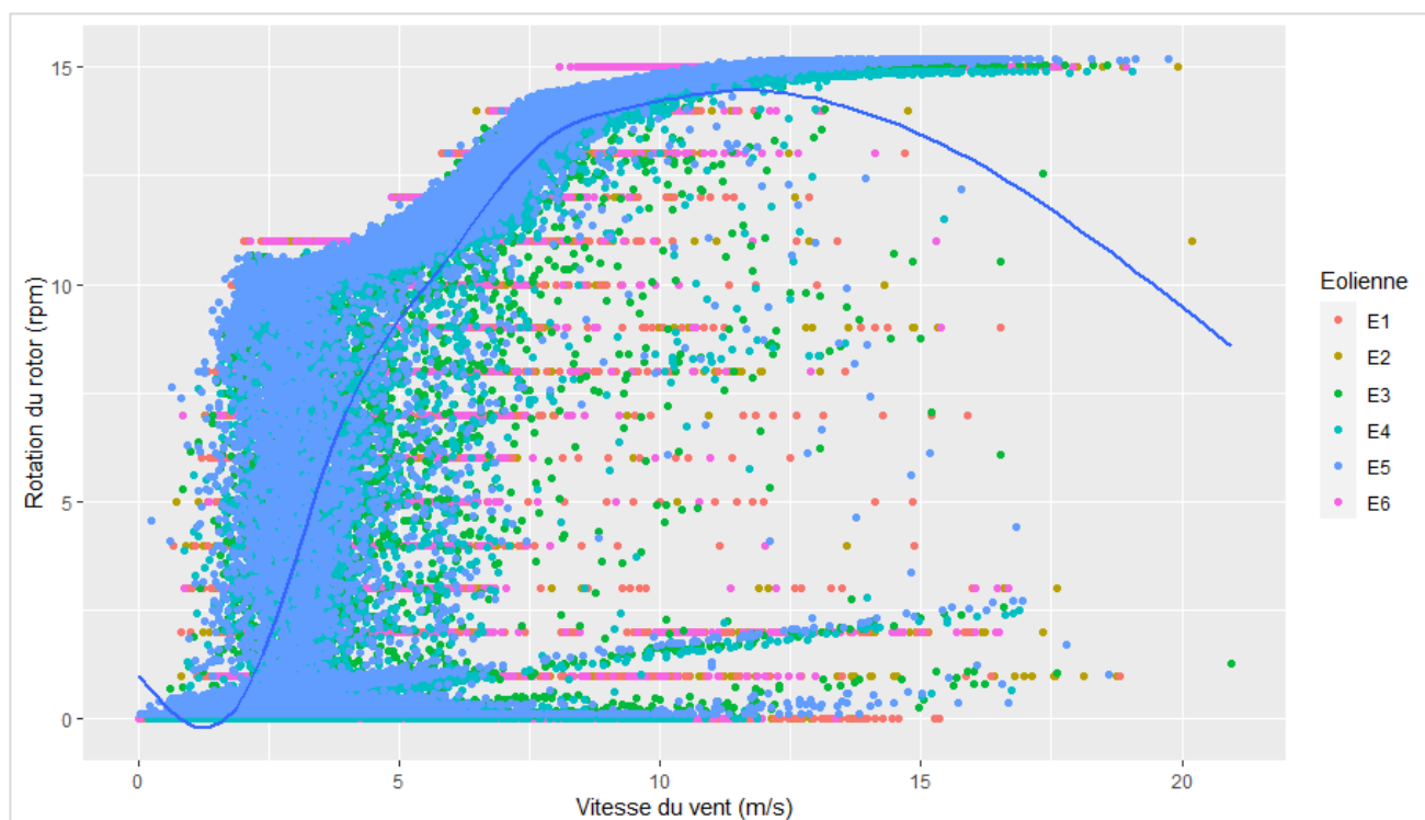
Figure 62 : Relation entre la vitesse du vent et la vitesse de rotation du rotor par tranche de 10 minutes sur toute la période d'étude avec application d'un modèle additif généralisé.
