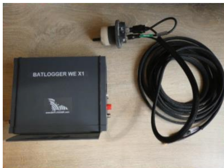
Figure 14 : Batlogger WE X1 avec micro MC32W
