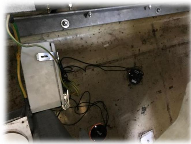
Batmode S+ installé dans la nacelle de l'éolienne E3 (Hugo Auclair - Écosphère)
