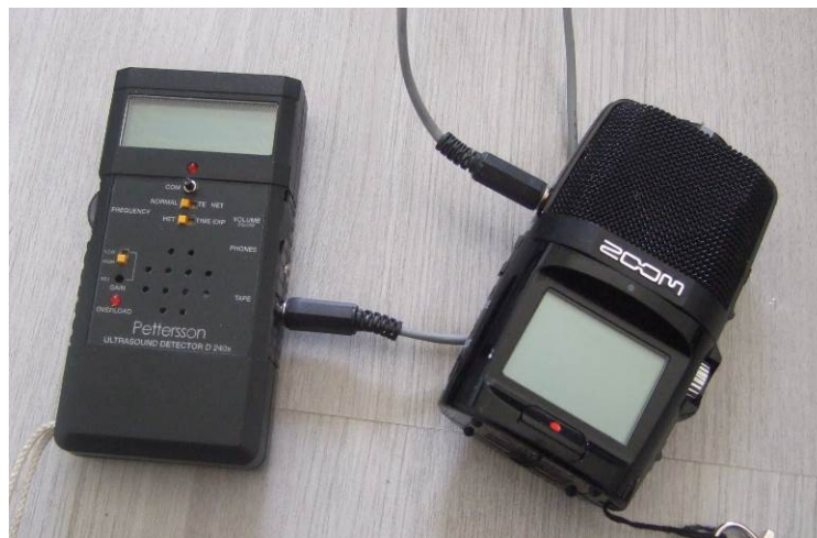
Détecteur d'ultrasons D240x et enregistreur ZOOMH2n. Ph. : R. Druesne.
