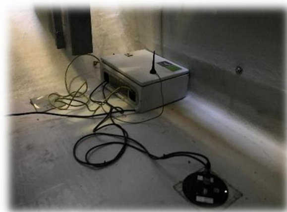
Batmode S+ installé dans la nacelle de l'éolienne E4 (J. AUCLAIR - Écosphère)
