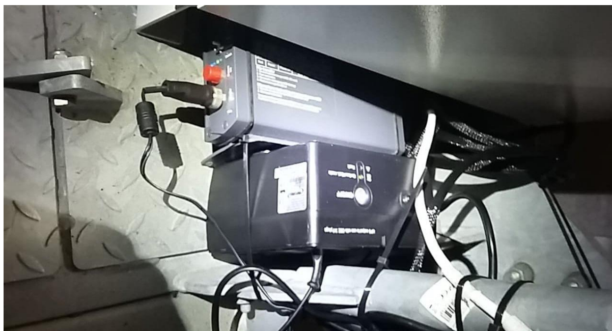
Photographie 9 : Détecteur et micro installés dans la nacelle de l'éolienne E1
