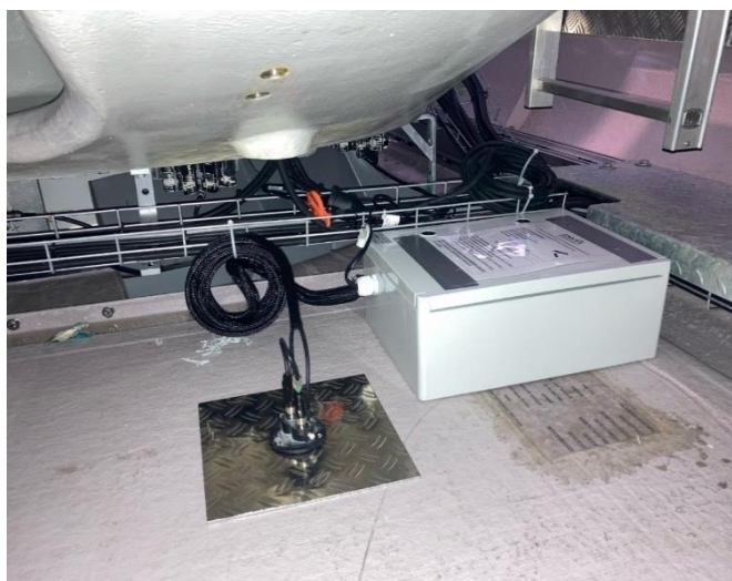
Exemple d'installation du Batlogger en nacelle
