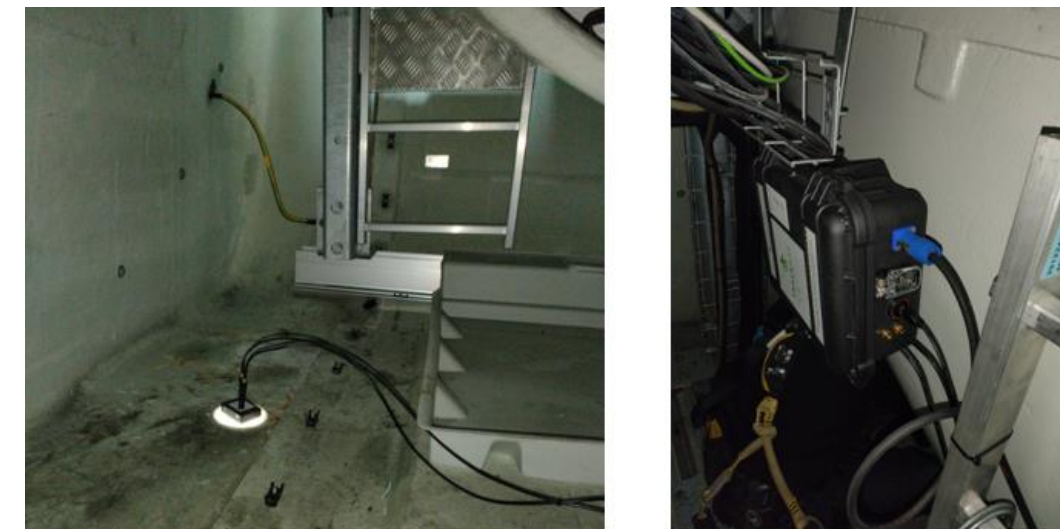
Figure 9 : Microphone installé pour les études en altitude (à gauche) et boîtier TrackBat avec microphones déportés, installé en nacelle de l'éolienne E2 sur le parc éolien de Plésidy (à droite).
