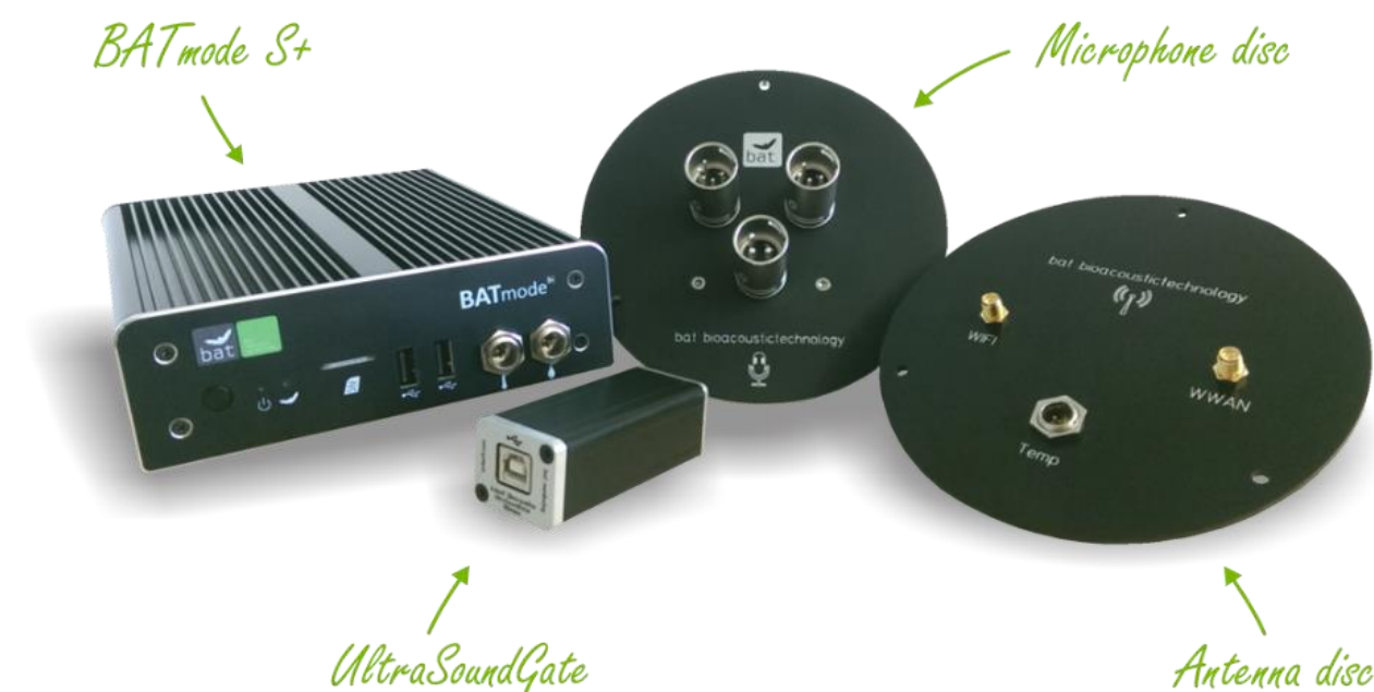
Figure 3 : Dispositif installé dans la nacelle d'éolienne (copyright : B.A.T.)
