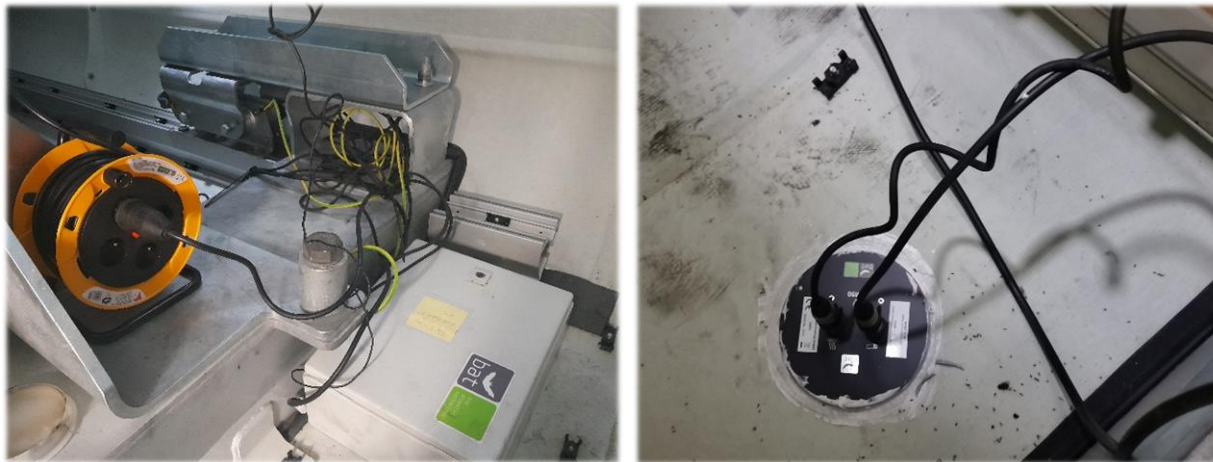
Batmode S+ installé en nacelle (TBM-Écosphère)
