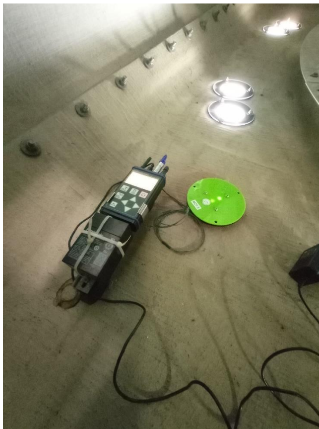
Figure 12 : GSM BATCORDER installé sur Clos-Neuf
