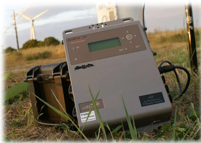
Photo 2: Détecteur / enregistreur d'ultrason SM3Bat – Source Amikiro
