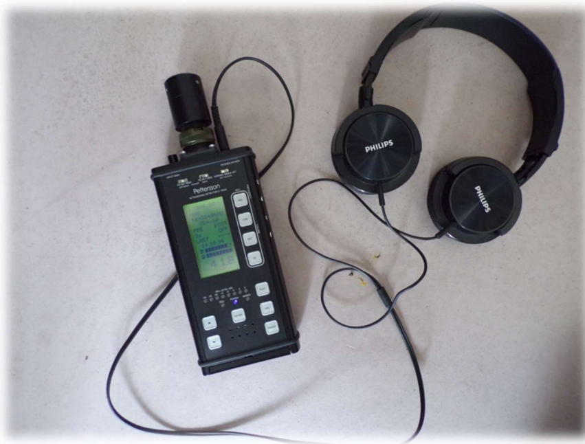
Photo 1: Détecteur d'ultrasons D1000x Pettersson Elektronik® - Source Amikiro
