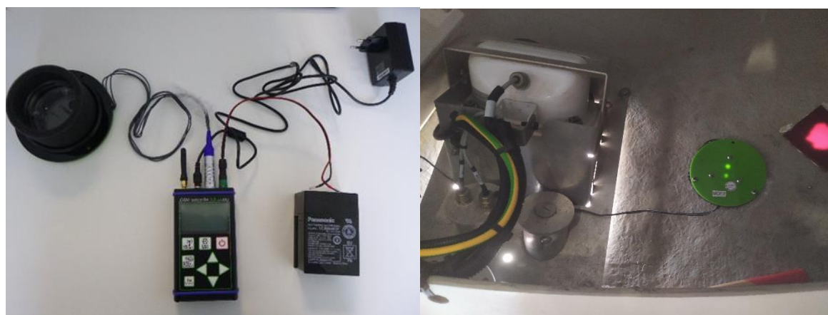
Figure 17 : À gauche : GSM-Batcorder, son micro et son alimentation. À droite : GSM-Batcorder installé sur Pouldergat
