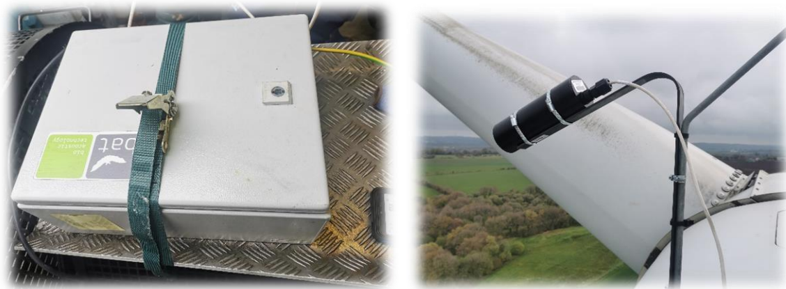
Boîte contenant le Smart et Micro déporté sur le toit de la nacelle (V.Guiho - TBM environnement)
