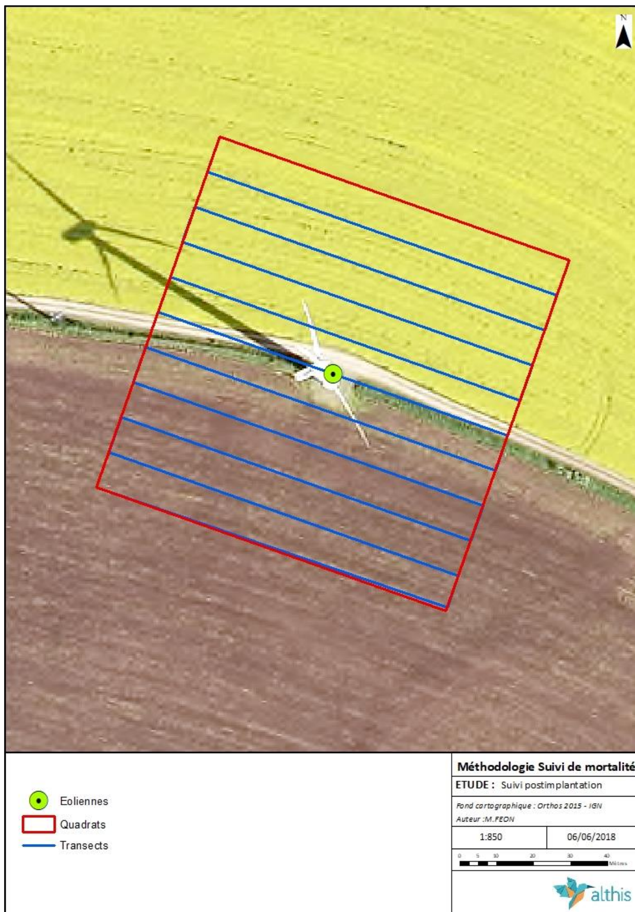
Figure 5 – Exemple de transect réalisé au pied de l'éolienne E2 du parc de Lanrivoaré
