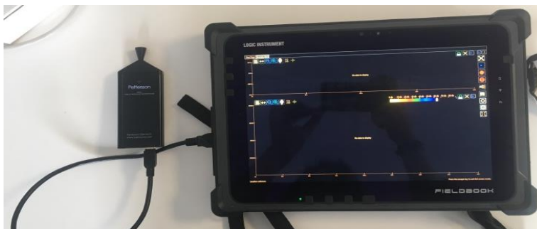
Photo 2 - Micro « Pettersson M500 USB Ultrasound Microphone » et logiciel « Batsound Touch » présent sur une tablette de terrain.
