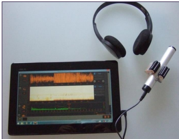
Figure 4 – Détecteur ultrasons SoundChaser de chez Cyberio
