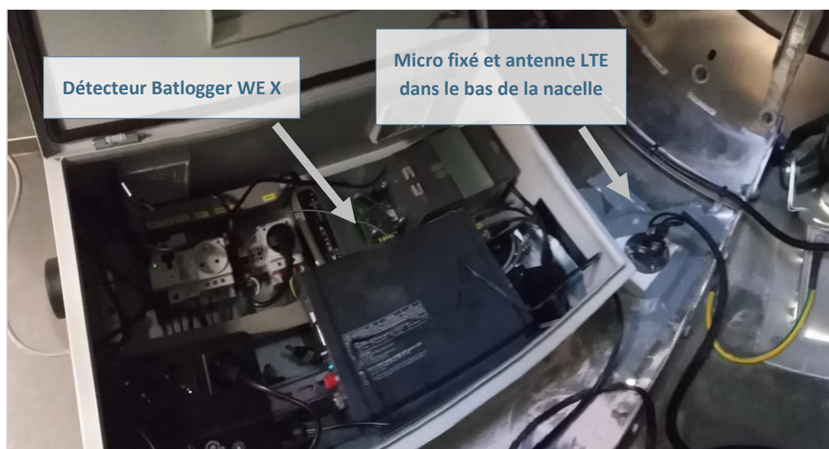
Photo 4 : Exemple de détecteur et micro installés en nacelle
