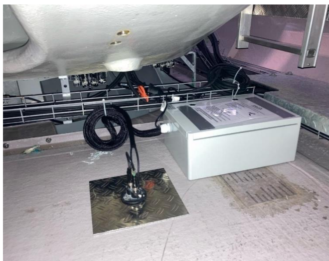
Exemple de Batlogger installé en nacelle
