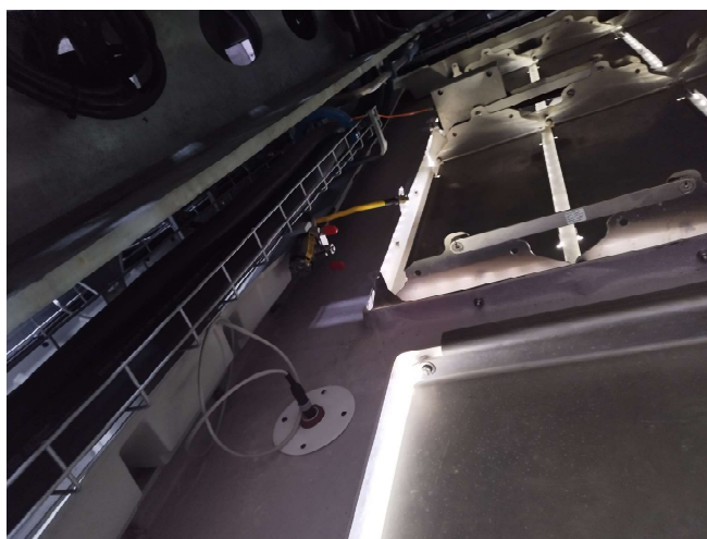
Photo de l'installation du microphone dans l'éolienne E3
