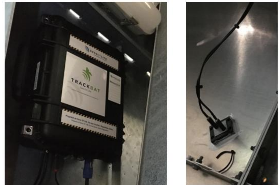
Figure 20 : Boîtier TrackBat (à gauche) et microphone déporté (à droite), mobilisés pour les études en altitude en nacelle de l'éolienne E2 du parc éolien de Saint-Morand
