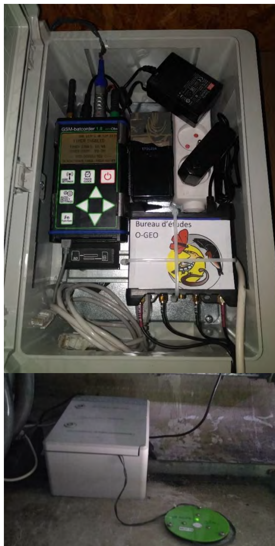
Photo. 1 : Batcorder GSM, module 4G et micro-disque installé sur le plancher de la nacelle de E5 (20/03/2022, O-GEO)
