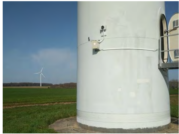
Photo. 3 : équipement de suivi de l'activité des Chiroptères au sol installé à 4 m de hauteur sur le mât de l'éolienne E5 (20/03/2022, O-GEO)
