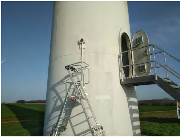
Photo. 2 : installation du micro-disque à 4 m de hauteur sur le mât de l'éolienne E5 (20/03/2022, O-GEO)
