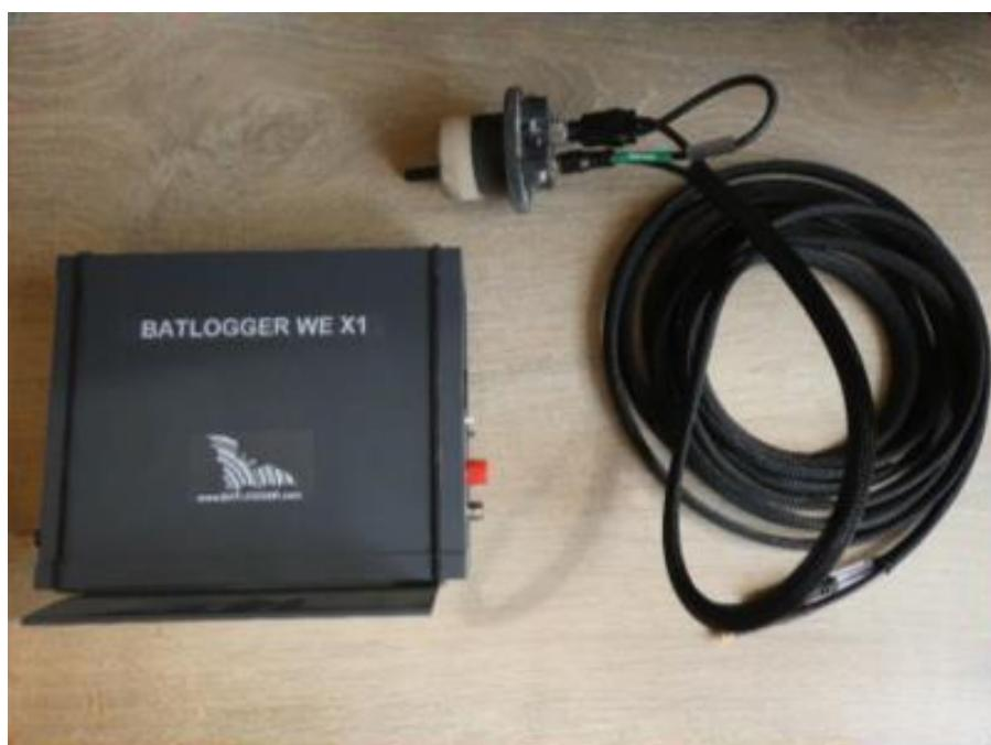
Figure 16 : Batlogger WE X1 avec micro MC32W
