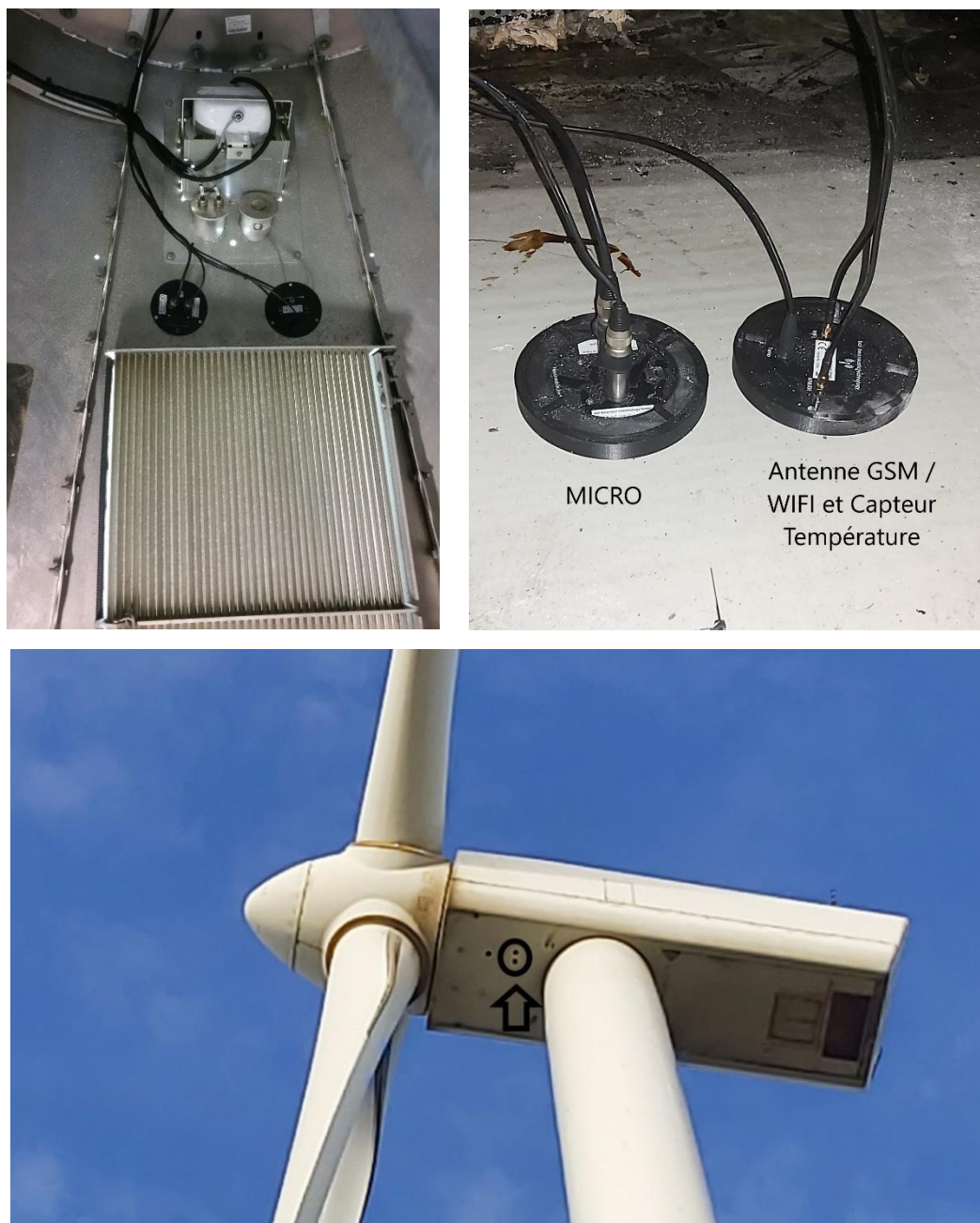
Figure 2 : Exemple d'installation d'un BATmode en nacelle
