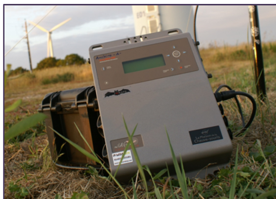
Photo 3: Détecteur/enregistreur d'ultrasons SM3Bat – Source Amikiro
