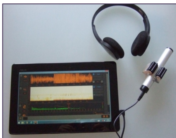
Photo 2: Détecteur d'ultrasons SoundChaser – Source Amikiro
