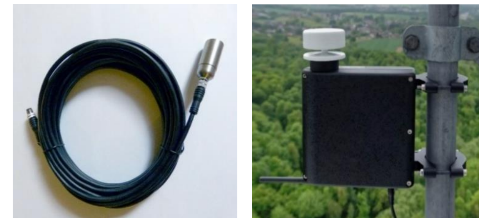
Figure 3 : Microphone mobilisé pour les études en altitude (à gauche) et boîtier TrackBat avec microphones intégrés, installé sur la nacelle d'une éolienne (à droite).
