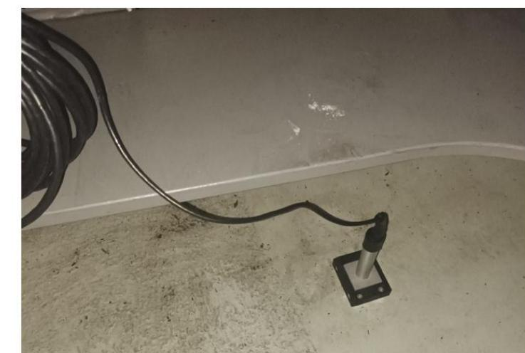
Figure 20 : Microphone mobilisé pour les études en altitude (à droite) et boîtier TrackBat avec microphones déportés, installé en nacelle de l'éolienne E1 (à gauche).
