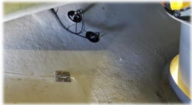
Partie arrière de la nacelle de l'Enercon™ : BATmode S+ installé dans un caisson avec un onduleur qui assure son alimentation continue. Le micro est branché sur un support disque orienté vers le sol au niveau de la coque près du moyeu (C. Heitz, Ecosphère).
