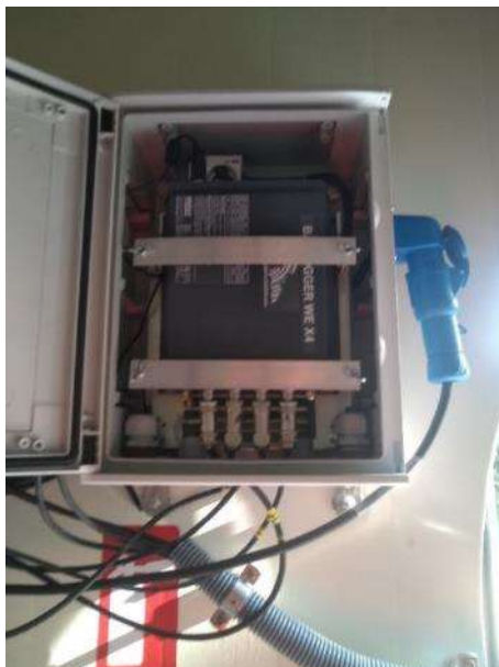
Figure 236 | Illustrations du dispositif d'écoute en nacelle et du positionnement micro sur la turbine
