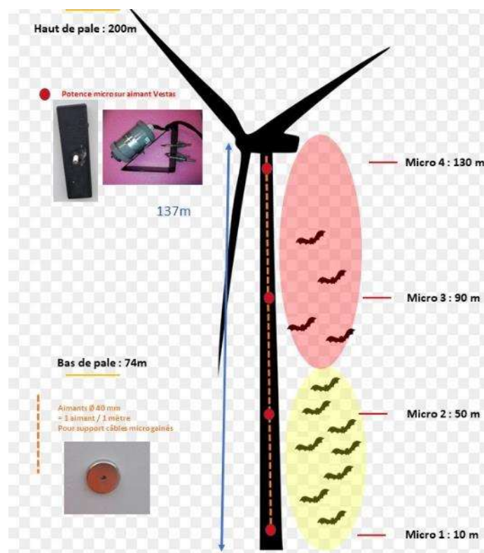
Figure 233 | Schéma d'installation du dispositif d'acquisition de données chiroptérologiques
