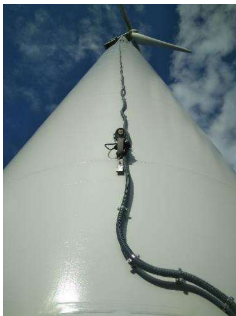
Figure 236 | Illustrations du dispositif d'écoute en nacelle et du positionnement micro sur la turbine
