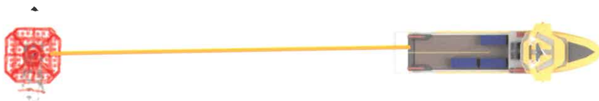
Figure 9 - Ombilical posé à l'écart de la fondation
