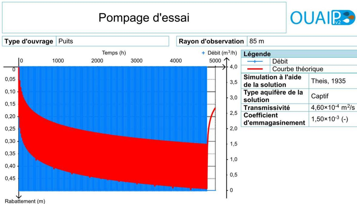
Le rabattement dans la zone humide située à 85 m du projet a été estimé à partir des données de transmissivité et de coefficient d'emmagasinement issues de la banque de données du SIGES BRETAGNE (rayon < 20 km autour du projet de forage). La simulation a été réalisée à partir d'un prélèvement de 6 heures 30 par jour à 4 m<sup>3</sup>/h soit 25 m<sup>3</sup>/jour pendant 200 jours sans prise en compte du phénomène de recharge de la nappe. L'effet du pompage sur la zone humide est estimé à 0,5 m.
