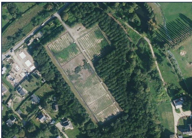
Figure 17 : Vue des filtres lents
