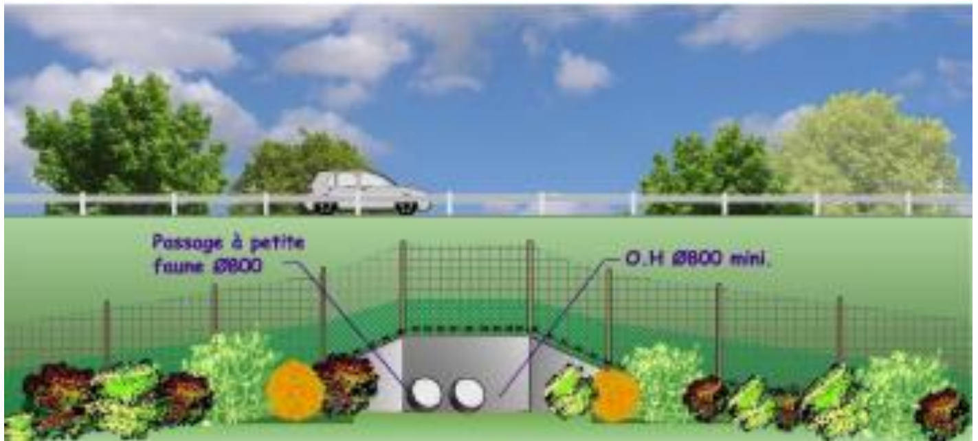
Figure 9.3: Dispositif pouvant être installé pour le passage de la petite faune (cf. DREAL Normandie)
