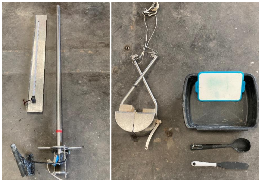
Figure 4 : Matériels de prélèvement - carottier et benne Van Veen
